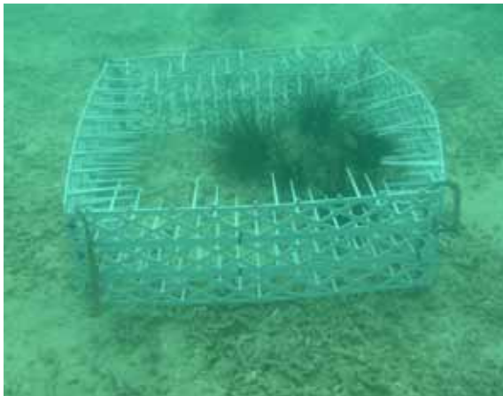
写真-2 横向きに設置した針状マット
